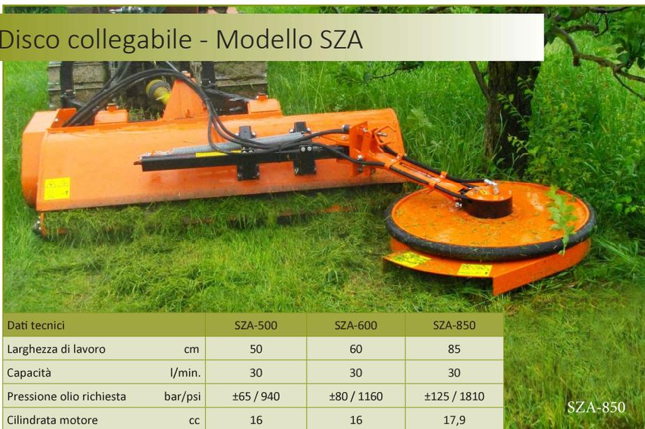
Il Solo-Swing è un giradischi con azionamento idraulico per pacciamatura intorno agli alberi, pali, recinzioni, ecc. Il disco di supporto SZA può essere fornito con supporti di fissaggio per il montaggio su trinciatrici rotative o trinciatrici.
