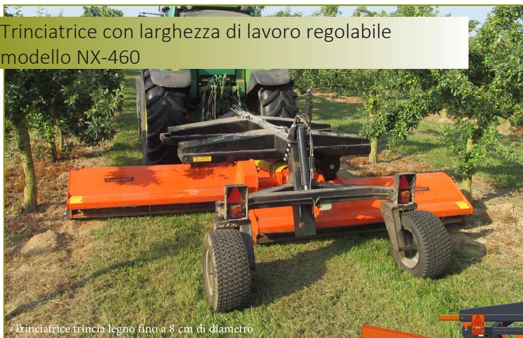
La trinciatrice NX-460 con larghezza di lavoro regolabile è costituita con un telaio speciale trainato con due trinciatrici da 240 cm di larghezza, che sono sospese nel telaio speciale. La sovrapposizione dei due trinciatrici è regolabile con i cilindri idraulici. Così è possibile regolare in modo semplice e continuo la larghezza di lavoro complessiva. La larghezza di lavoro complessiva può essere estesa da 290 cm a 460 cm.
